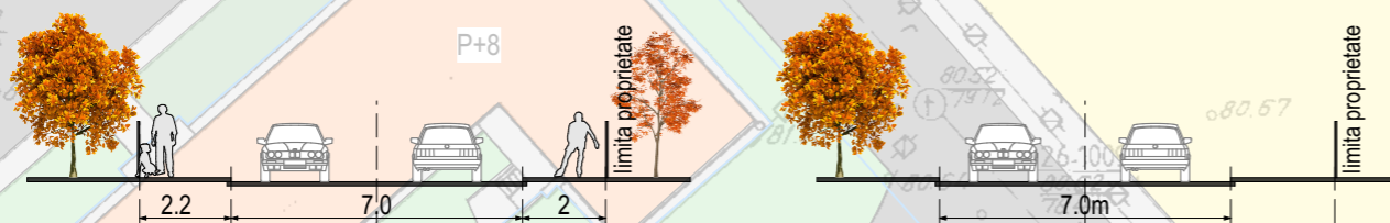
Profil A-A - str. Bujorul Alb - existent si mentinut, sc. 1:200
